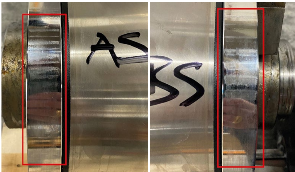
Bild 3: Charakteristische Rattermarken (rote Markierungen) auf den Laufflächen der Schmitzringe (antrieb- und bedienseitig) nach den Kanälen.
